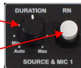
Régler le bouton *DURATION* sur “max” et appuyer sur le bouton RN pour réécouter l’intégralité des 12 dernières secondes enregistrées.
