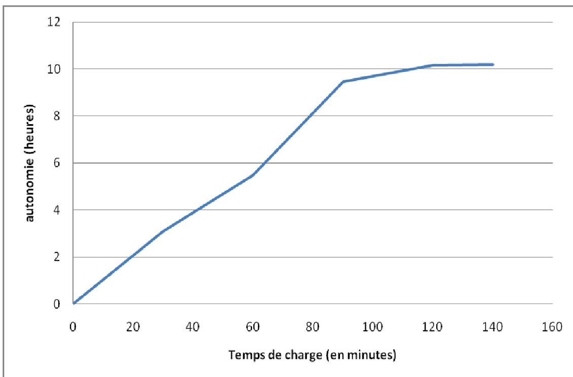
*Autonomie en fonction du temps de charge (courbe moyenne sur une batterie neuve)*
